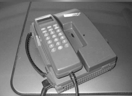
**D-Netz-Mobilfunkeinheit aus dem Auto herausnehmbar um 1991**
