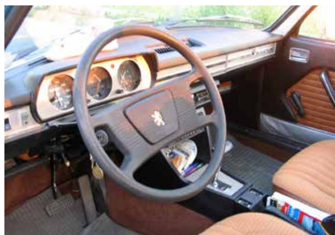
Arbeitsplatz der 2. Serie: drei Rundinstrumente – umschäumtes Lenkrad – Automatikhebel und Handbremse in der Mitte
