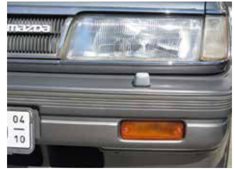
Klare Einteilung der Frontbeleuchtung mit Reinigungsdüsen
