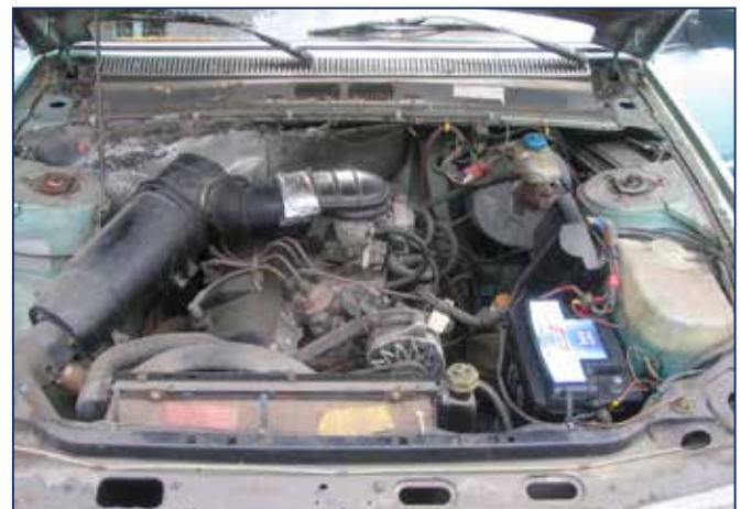
Bewährter 2l-Vergaser-Motor aus dem 504, bis 1985 im Programm
