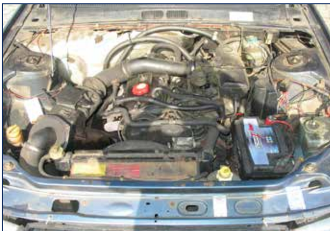
Zahnriemen gesteuerter 2,2 Liter-Einspritzmotor, ab 1982 mit L-Jetronic
