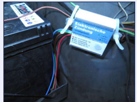
Zu Testzwecken erst einmal provisorisch befestigtes Transistor-Zündmodul
