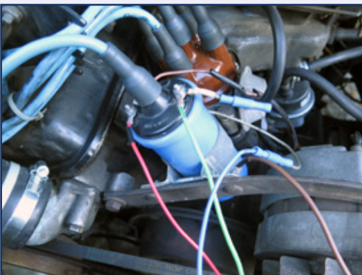
Elektrischer Anschluss – rot an Plus-Zündspule Klemme 15 – braun an Masse – grün an Klemme 1 und blau zum Unterbrecher
