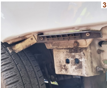
Bild 3: Defekte Stoßstangenhalterung R19 – notdürftig mit Blechstreifen geflickt
