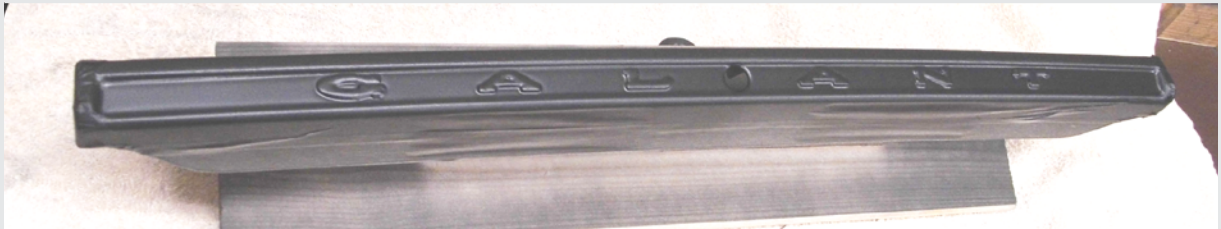
Sodann die Flächen abgeklebt, die in Chromoptik erscheinen sollen.
